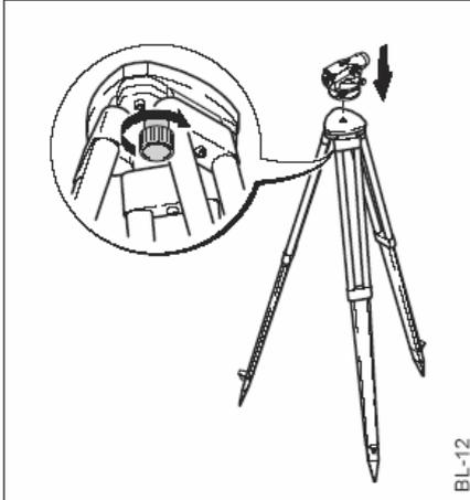
1. Установите нивелир на штативе. Затяните закрепительный винт.
