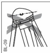
При установке штатива обращайтесь внимание на то, чтобы головка штатива была горизонтальна. Значительный наклон штатива должен корректироваться с помощью подъемных винтов трегера.
