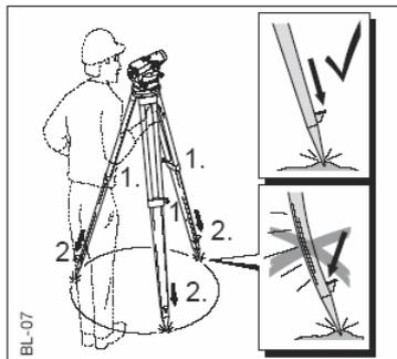
1. Ослабьте винты на ножках штатива, выдвиньте ножки на нужную высоту и хорошо затяните винты.
