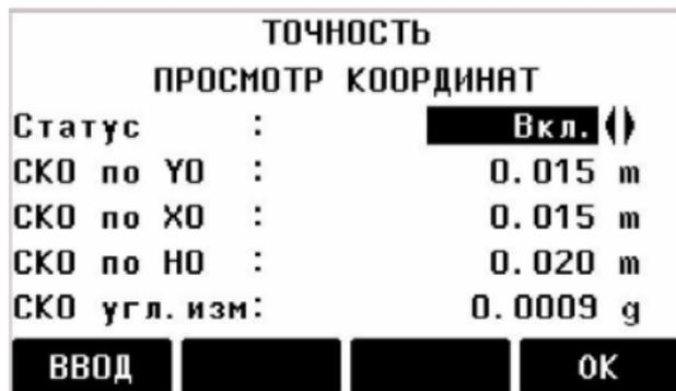
Здесь можно ввести значения допустимых СКО по всем трем координатам и для горизонтальных углов. При выходе вычисленных по результатам измерений значений СКО за установленные в этом окне допуски система выведет на дисплей окно запроса, где будет нужно решить, продолжать измерения или нет.
