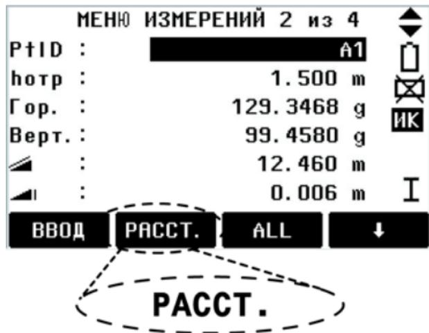
Дисплейные клавиши, расположенные в нижней части экрана, имеют надписи, которые индицируют прописанные для них команды и функции. Их можно использовать с помощью соответствующих функциональных клавиш. Доступные с помощью дисплейных клавиш
